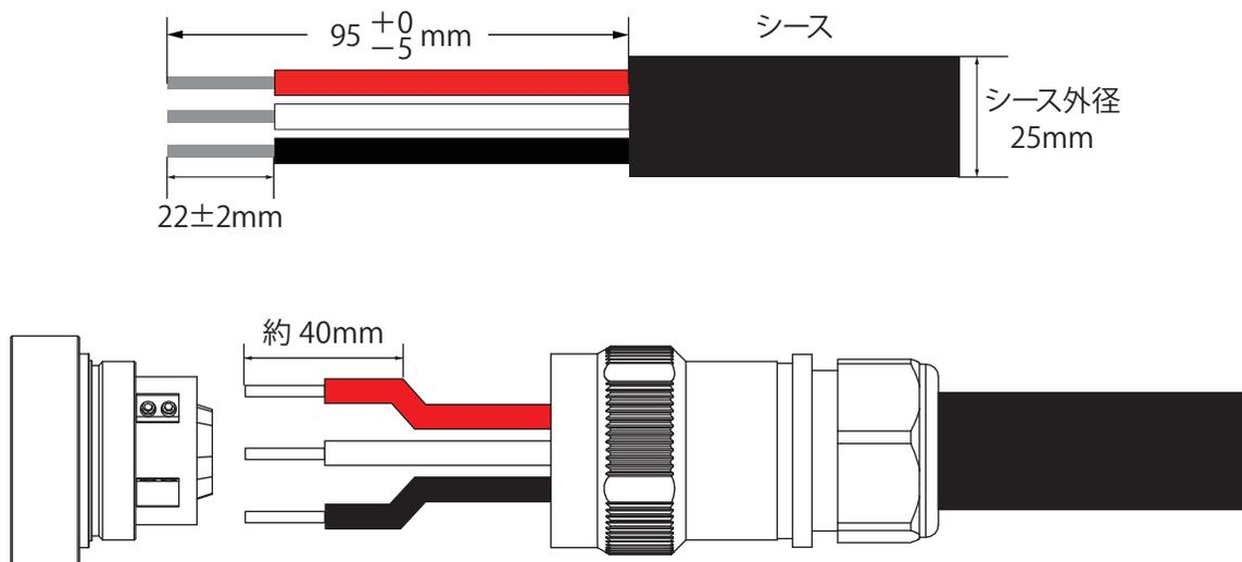
図 5-2 AC ケーブルのシース剥ぎ取り
