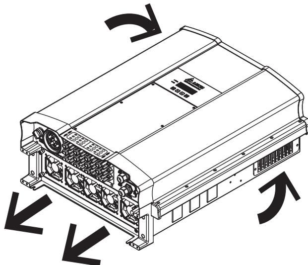
図 3-6 ファンの吸気・排気口イメージ図
