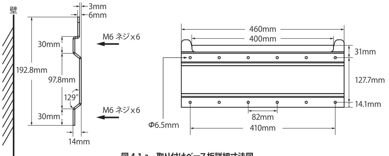
図 4-1-a 取り付けベース板詳細寸法図
