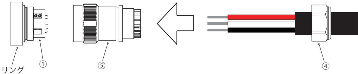
5. 銅線部がプラグの穴にまっすぐ刺さるように、ケーブルを頭から約 40 mm の部分で曲げます。このとき、シースがプラグの中心になるように曲げを調整してください。
