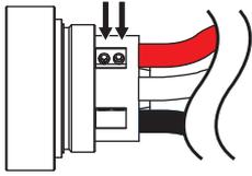
7. AC プラグ①の先端を固定しながら、ケース⑤を回し取り付けます。
