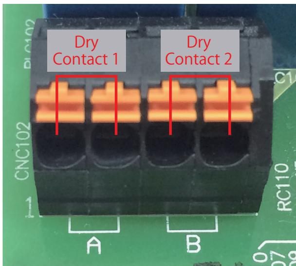
図 5-11 無電圧接点の定義図
