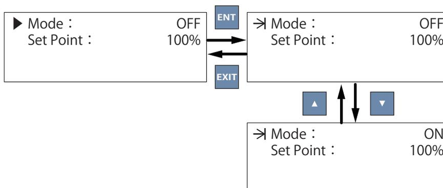
※パワーコンディショナの発電量が設定値を超えた場合、Alarm (赤) の LED ランプが点滅し、Status に「Derating」と表示されますが、出力を制御していますので、故障ではありません。
