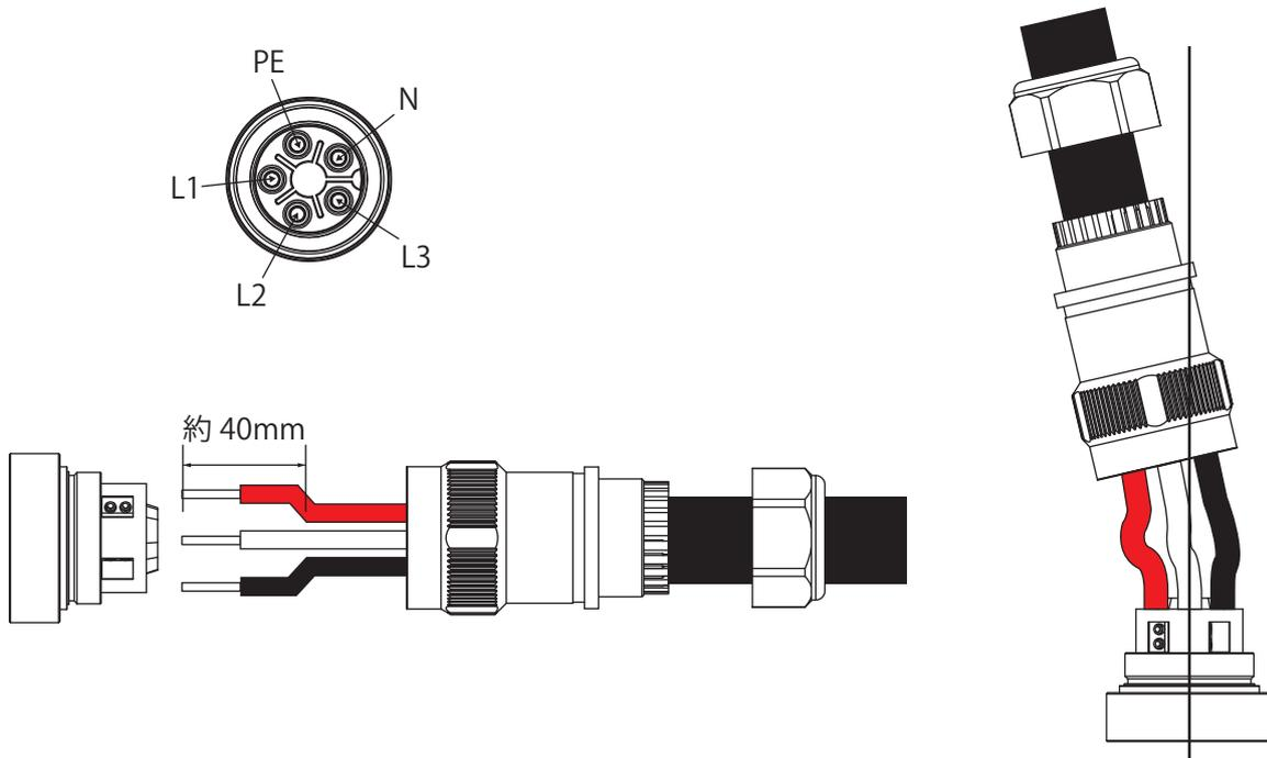
6. しっかり奥までケーブルを挿し込んだら六角レンチ（ $\phi 3\text{ mm}$ ）でケーブルを固定してください。
