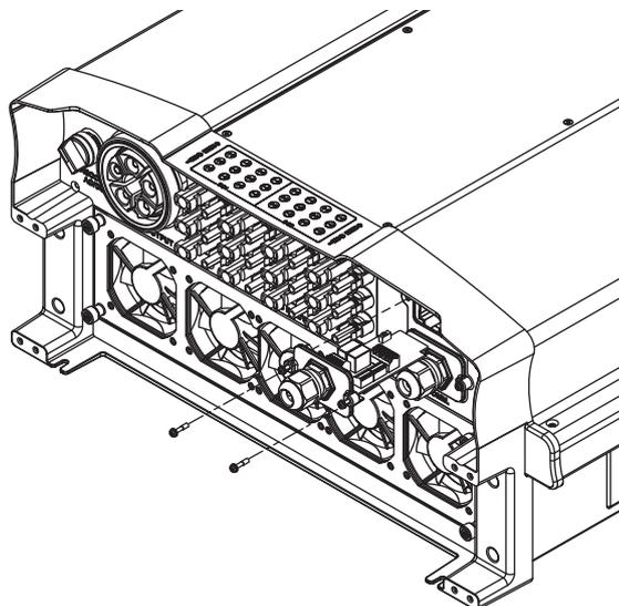
図 5-7 通信モジュールの外し方
