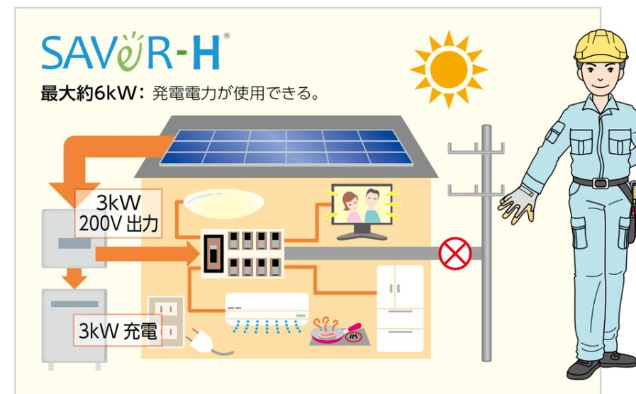
十分な太陽光と太陽電池パネルがあれば、セイバーHは最大6kW(\*5)の電力を発電、利用することができます。6kWのうち、3kW(\*5)を宅内の電気機器に、残りの3kW(\*6)を蓄電池の充電に回します。充電に要する時間は、ES6JB1(5.6kWhモデル)で最速2時間半、ES6JB2(11.2kWhモデル)なら最速4時間半でフル充電します。
